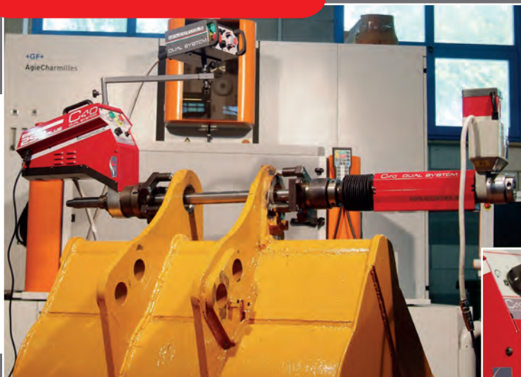
La C40 Dual System, modelo STD 250 Plus, en fase de mandrinaje encima de la cuchara de una excavadora, con máquina desdoblada y no
