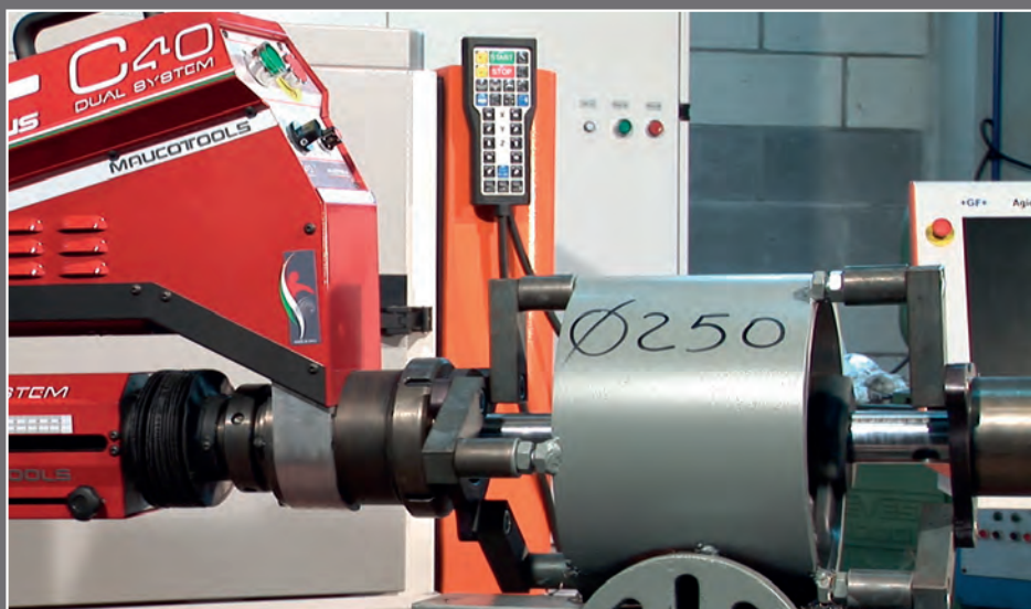
La C40 Dual System, modelo STD 250 Plus, en fase de trabajo en un diámetro de 250 mm
